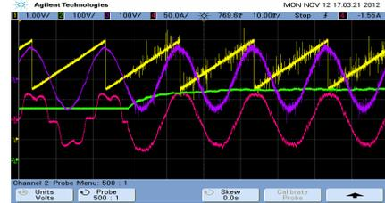
CH1: A 相电网电压 CH2: A 相电网电流
